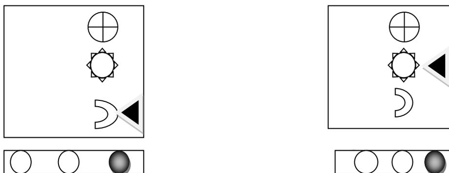
Utiliser le 3ème bouton (à droite) pour déplacer la flèche qui commande le chauffage
